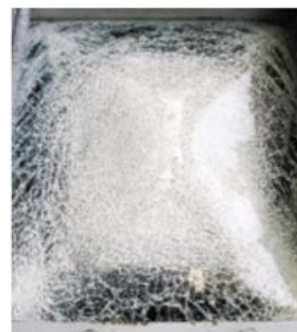
Test de résistance à une déflagration : EN 13541
