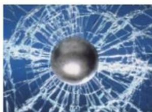
Test de résistance à l'impact d'une bille d'acier - EN 356
